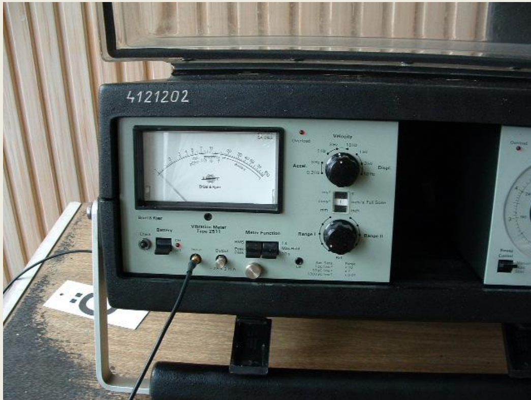
4. fotó: Rezgés mérő műszer mérés közben
